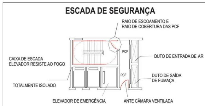
Figura 41: Escada e elevador à prova de fumaça.
