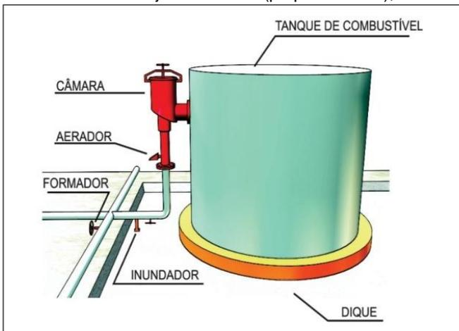
Figura 63: Detalhe de câmara de espuma.
