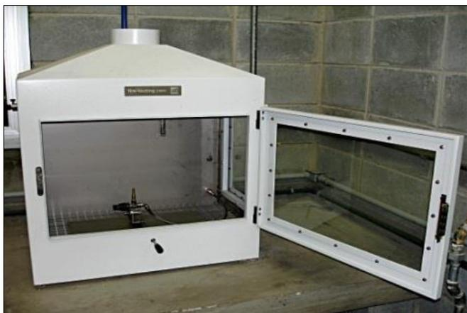
**Figura 35:** Determinação da ignitabilidade dos materiais.
