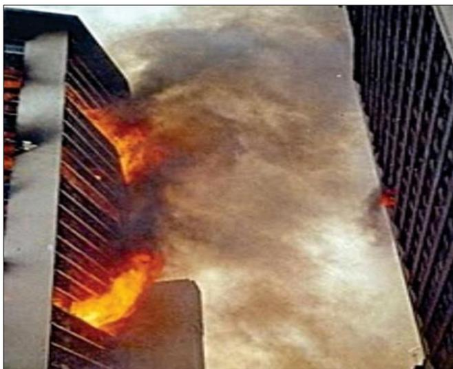
**Figura 21:** Propagação por convecção, onde gases quentes fazem com que ocorram focos de incêndio em outros andares.
