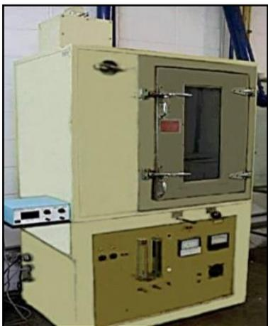
**Figura 32:** Câmara de densidade óptica fechada.
