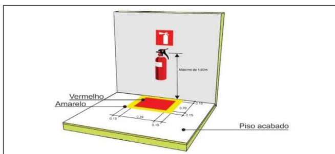
Figura 54: Detalhe de instalação de extintores em áreas sujeitas à obstrução.
