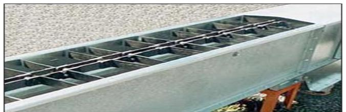
Figura 20: Transportador de corrente
