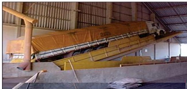
**Figura 10 –** Plataforma de descarga (tombador agrícola).
