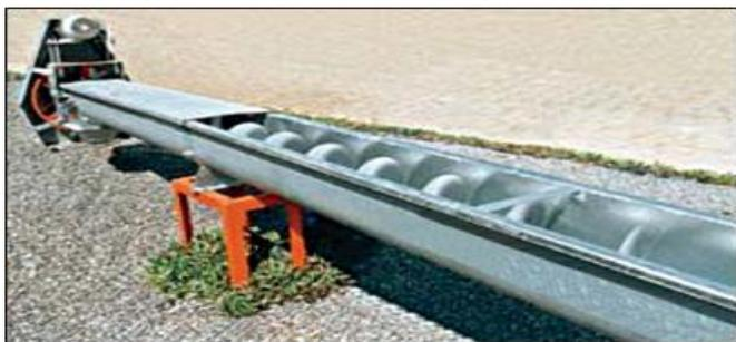
Figura 21: Transportador helicoidal
