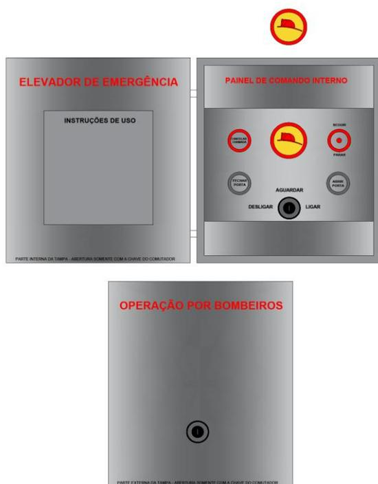
Figura 28: Exemplo de painel de comando interno (comutador interno)
