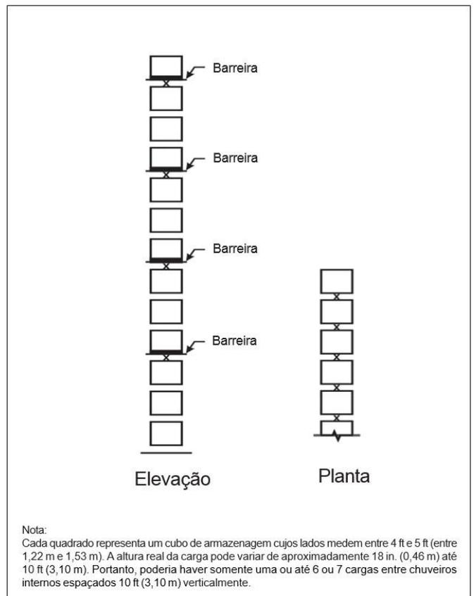
**Figura 5.3.4.4.1.2(d):** Distribuição de chuveiros internos, mercadorias Classe I, Classe II, Classe III ou Classe IV, estruturas porta-paletes simples, altura de armazenagem acima de 7,6 m (25 ft) – **Opção 2.**
