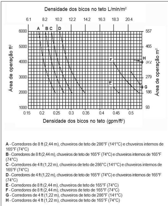
**Figura 5.3.2.1.2(e):** Estruturas porta-paletes simples ou duplas - Armazenagem a 6,1 m (20 ft) de altura em estruturas porta-paletes - Curvas de projeto de sistemas de chuveiros - Mercadoria Classe I e II encapsulada - Paletes convencionais.
