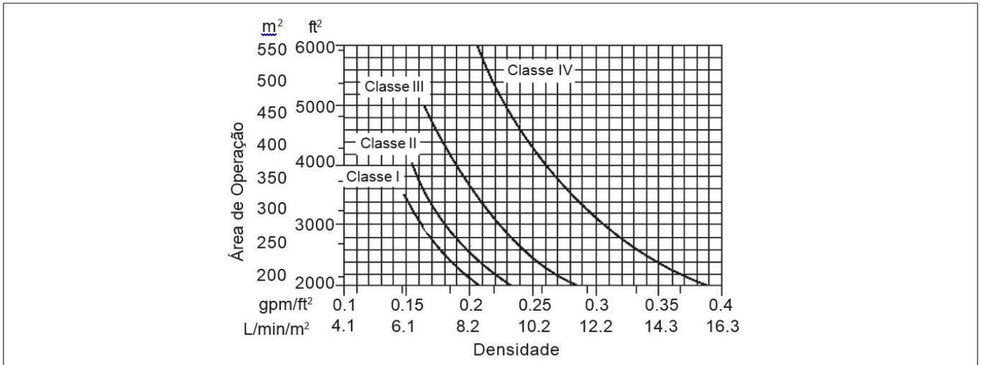
**Figura 5.2.2.1.5.1:** Curvas de projetos de sistemas de chuueiros, armazenagem 6,1 m (20 ft) de altura – chuueiros de temperatura normal.
