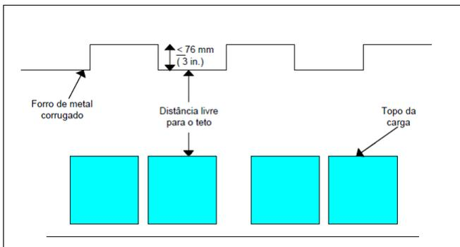
Figura E.2: Forro de metal corrugado com profundidade  $\leq 76$  mm.
