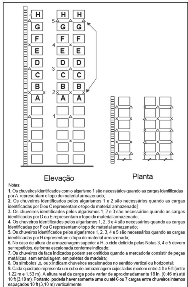
**Figura 5.3.4.4.1(d):** Distribuição de chuveiros internos, mercadorias Classe I, Classe II ou Classe III, altura de armazenagem acima de 7,6 m (25 ft) – Opção 1.
