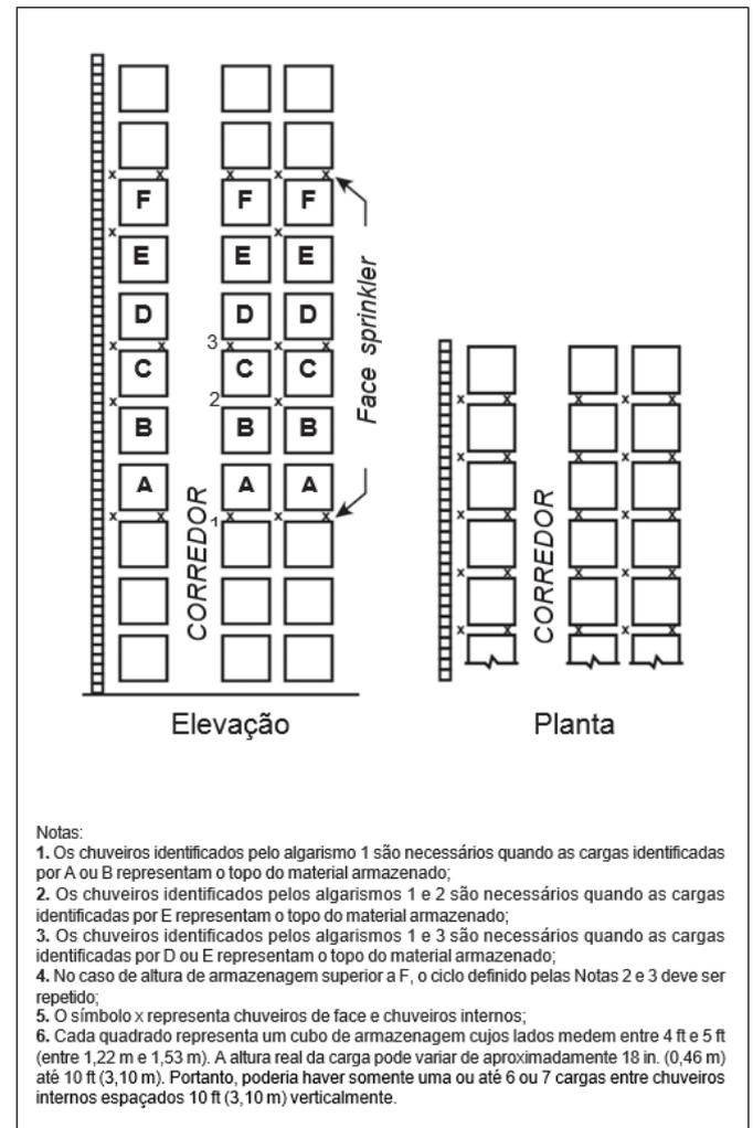
**Figura 5.3.5.1.2(b):** Distribuição de chuveiros internos, plásticos grupo A, altura de armazenagem acima de 7,6 m (25 ft) – **Opção 2.**
