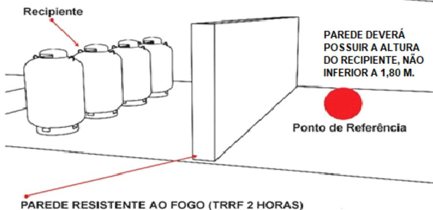
Figura 09: Exemplo de interposição de parede corta-fogo
